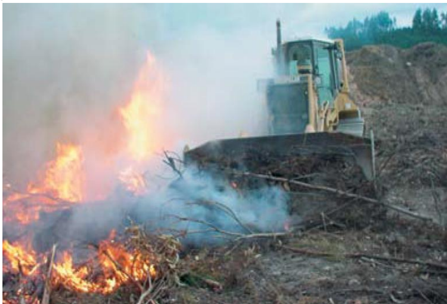
Figura 200 – Combate indireto com remoção da vegetação. Fonte: Portugal, 2006.
