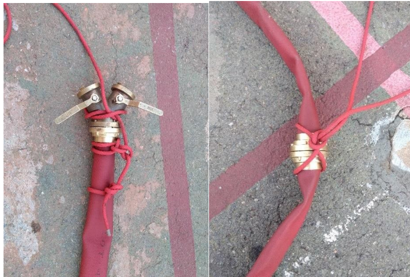
Figura 1 - Amarrações na ligação para içamento
