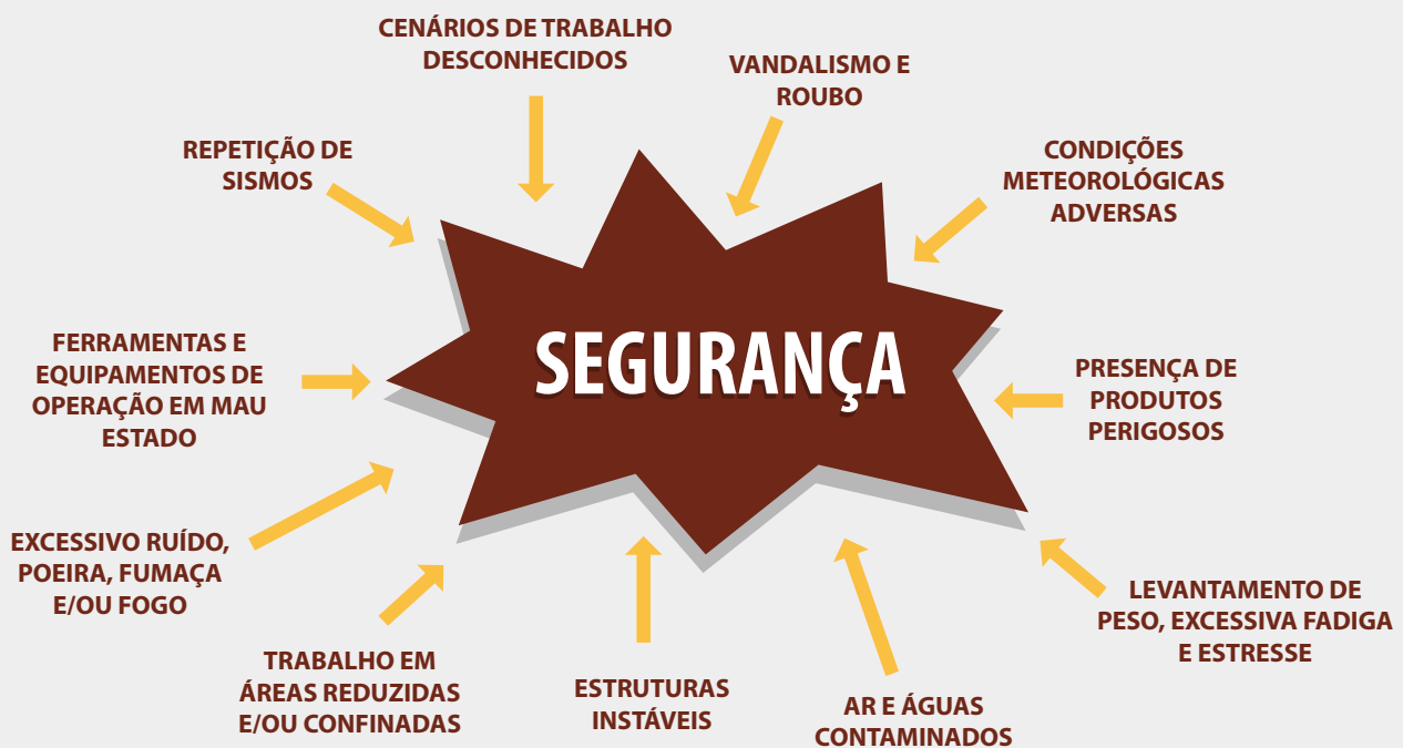
Figura 8 – Exemplos de ameaças enfrentadas pelos resgatistas em operações de BREC Fonte: Manual do curso de resgate em estruturas colapsadas – Nível Leve – OFDA/USAID
