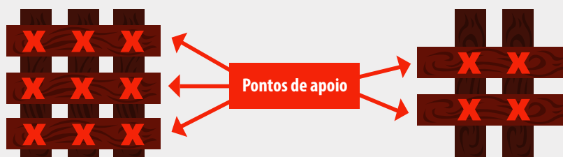
Figura 56 – Exemplo de pontos de apoio
