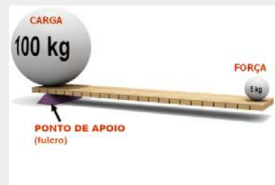
Figura 48 – Princípio da alavanca
