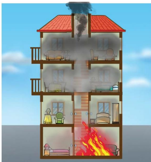
Abertura feita no teto - Ventilação vertical
