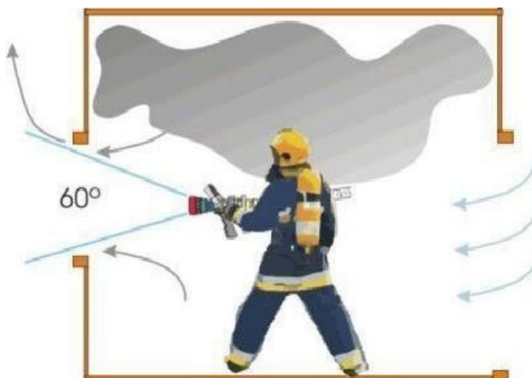
Posicionamento para ventilação por arrastamento hidráulico
