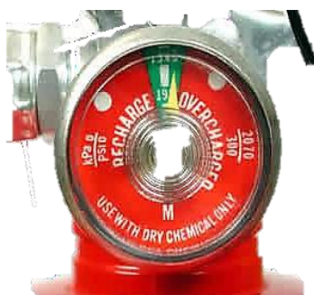
Figura 39 – Manômetro de extintor de incêndio
