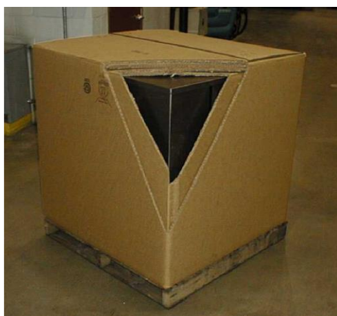
Figura 11: Classe II: metal embalado em dupla caixa de papelão ondulado de parede tripla, sobre paleta de madeira
