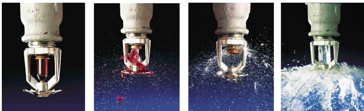
Figura 5: Operação de um chuveiro automático
