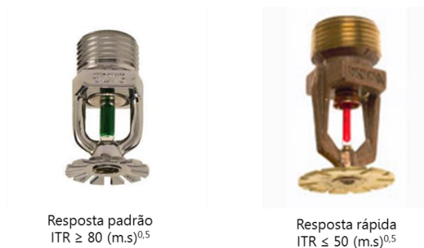
Figura 24: Chuveiros automáticos de resposta padrão e resposta rápida
