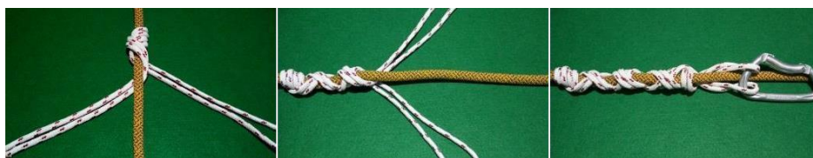
Confecção do Sistema Autoblocante Trançado. Fonte: CBMGO
