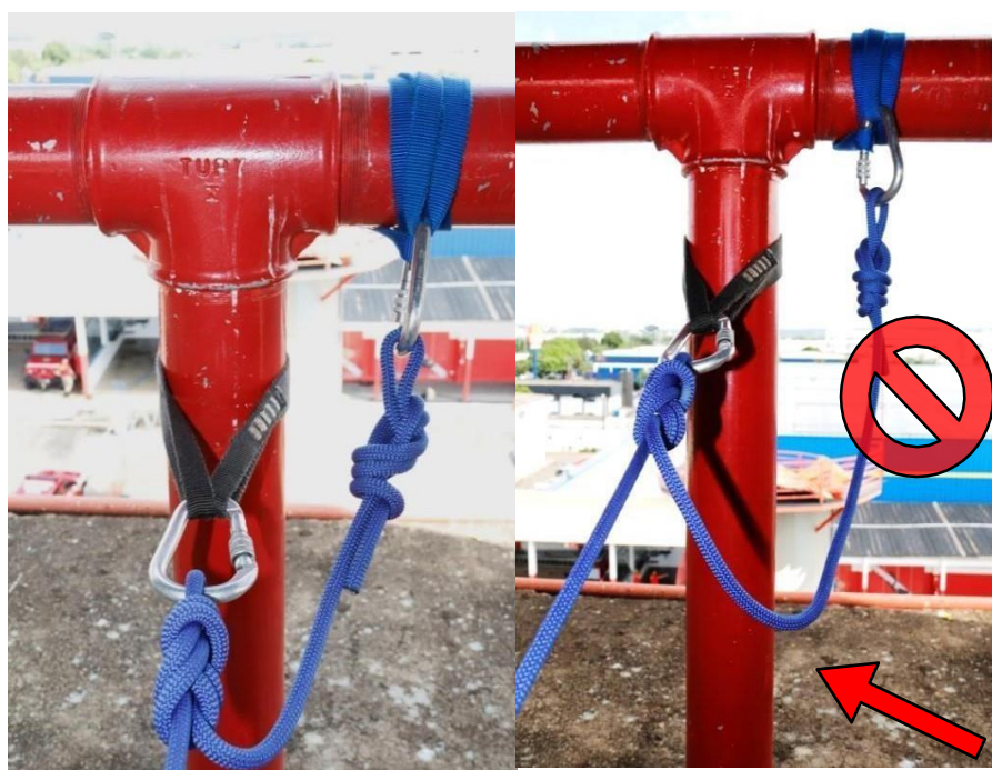
Ancoragem em ponto bomba com utilização de Back-Up e demonstração de falha na execução de uma ancoragem. Fonte: CBMGO.
