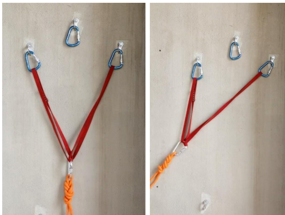
Ancoragem equalizada em “V” com Magic X com alteração da direção da via de descida. Fonte: CBMGO.
