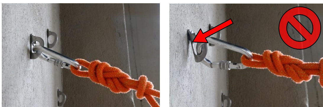
Ponto Artificial tipo Chapeleta e demonstração das formas de utilização. Fonte: CBMGO.
