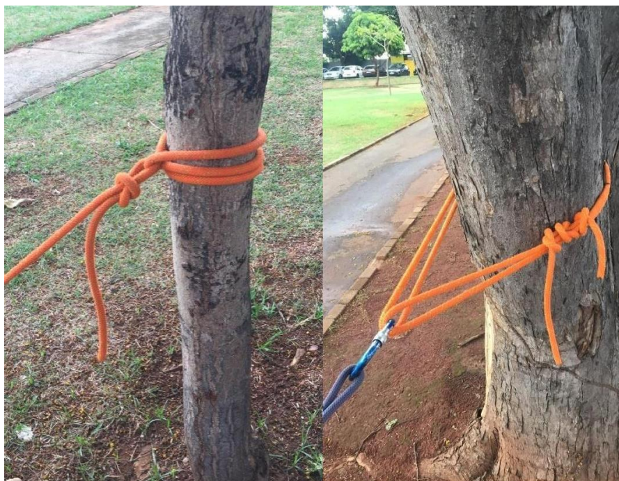
Ponto Natural com utilização do próprio cabo de descensão e também com cabo solteiro. Fonte: CBMGO.
