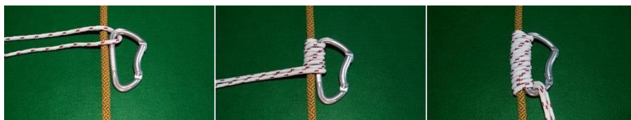
Confecção do Sistema Auto-blocante com Mosquetão. Fonte: CBMGO
