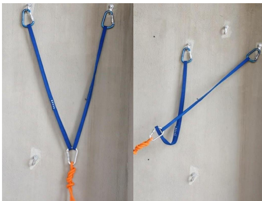
Ancoragem em “V” Pseudo-Equalizada utilizando anel de fita. Fonte: CBMGO.
