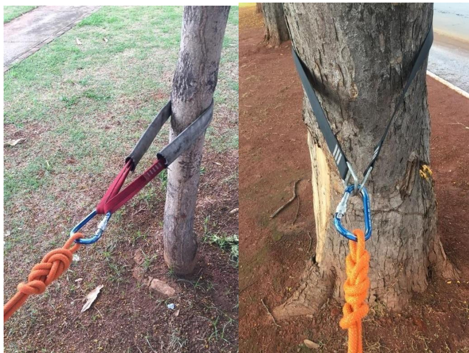
Ponto Natural com utilização de anel de fita e capichama. Ancoragem Natural com fita de ancoragem. Fonte: CBMGO.
