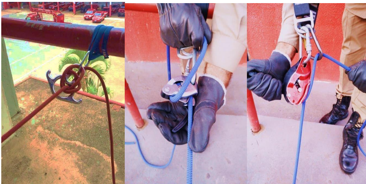
Ancoragem Móvel com oito de resgate, Gri-Gri e l'D. Fonte: CBMGO.
