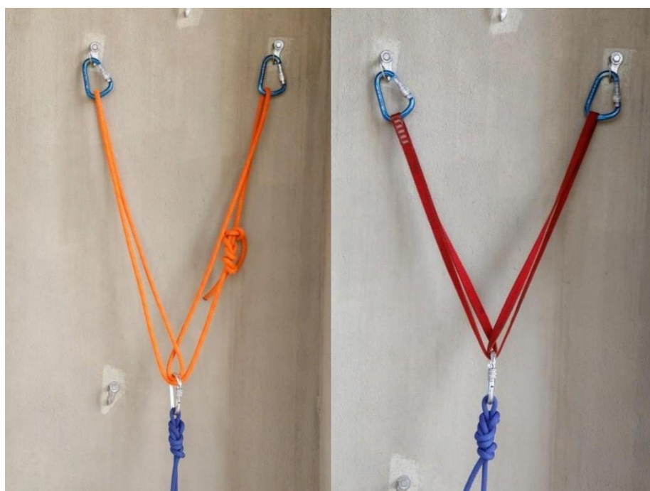
Equalização em “V” com Cabo Solteiro e Equalização em “V” com anel de fita. Fonte: CBMGO.
