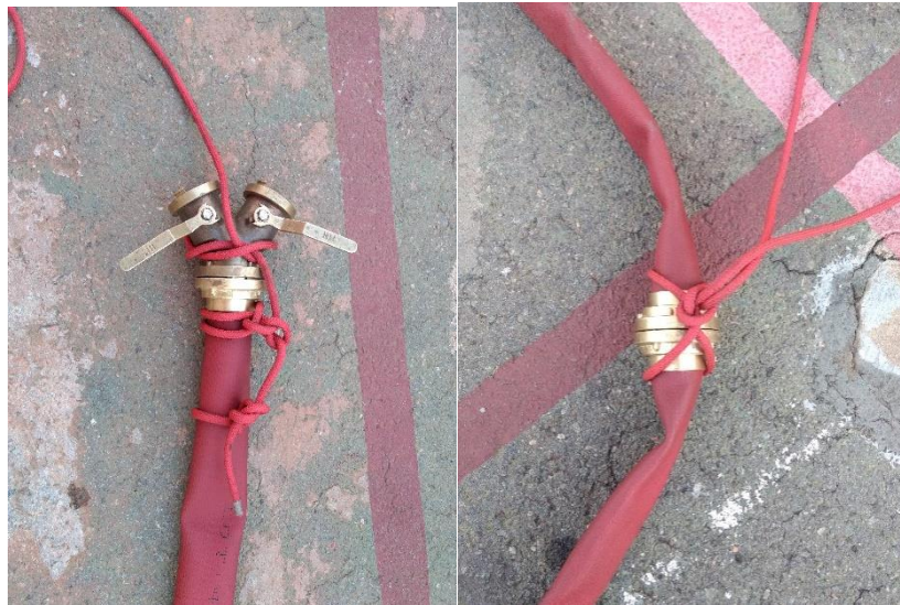
Figura 1 - Amarrações na ligação para içamento
