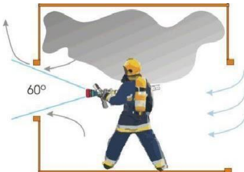
Posicionamento para ventilação por arrastamento hidráulico
