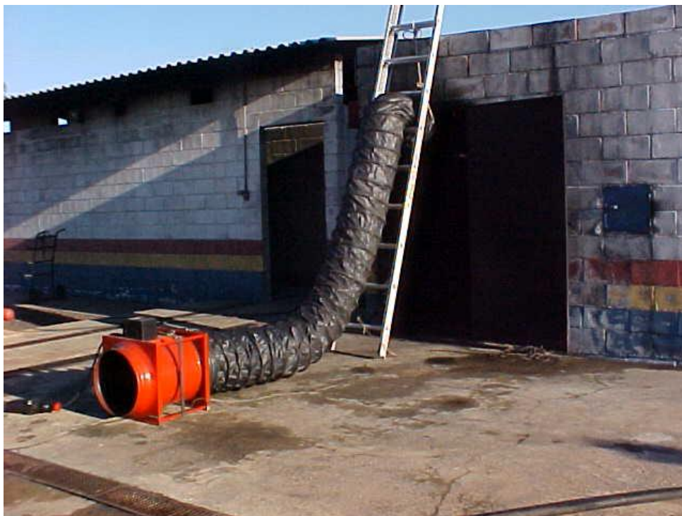
Posicionamento do exaustor para a VPN Fonte: CBM-SP - MVP, 1ª edição - Página 63
