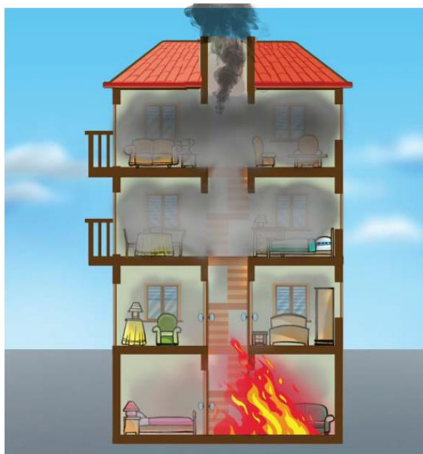
Abertura feita no teto - Ventilação vertical
