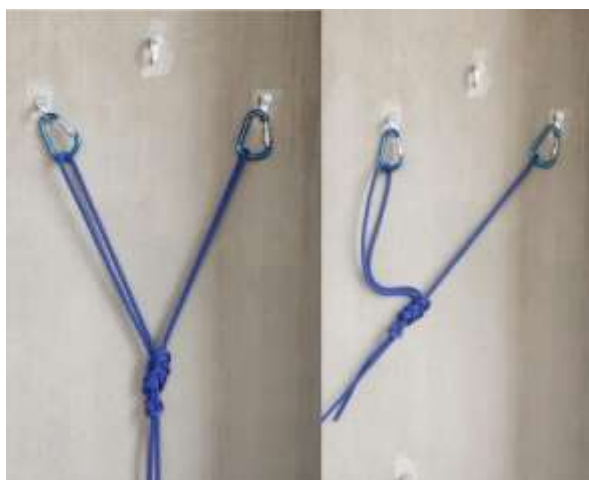
Ancoragem Pseudo-Equalizada utilizando cabo de descensão com nó oito duplo alçado, alterando a direção da via.
