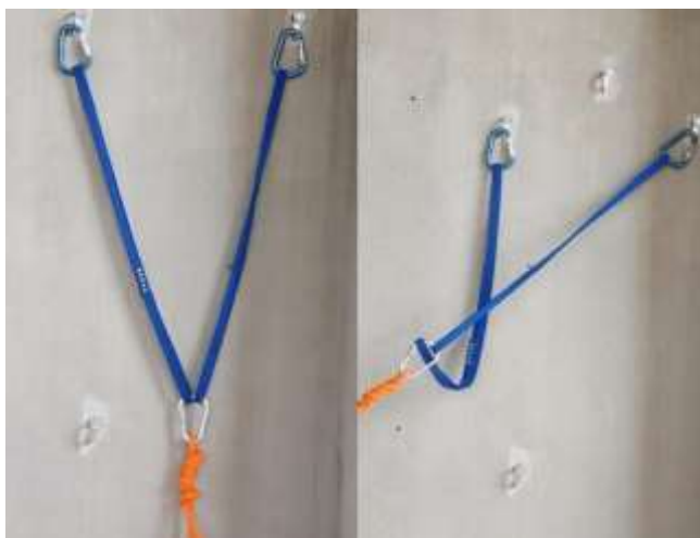
Ancoragem em “V” Pseudo-Equalizada utilizando anel de fita.
