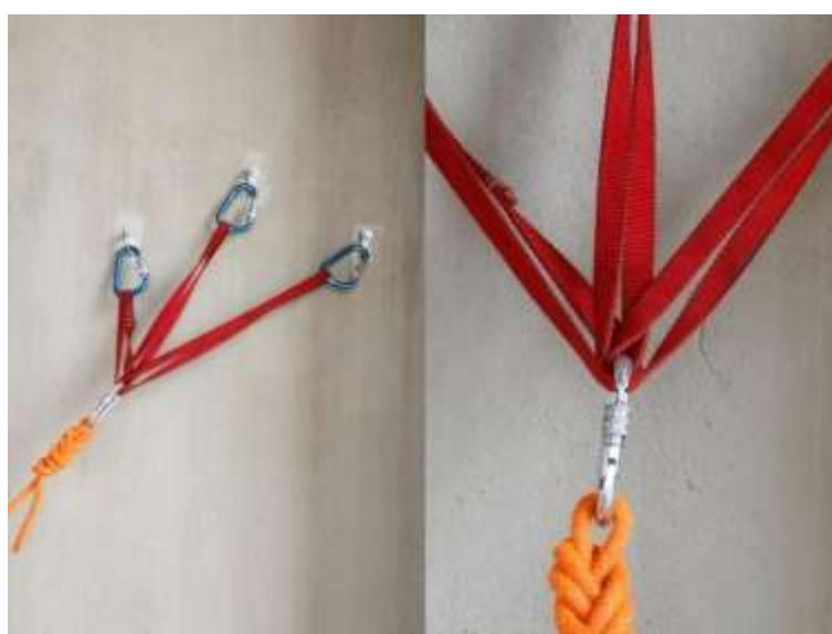
Ancoragem equalizada em “W” com Magic X com alteração da direção da via dedescida. Fonte: CBMGO.
