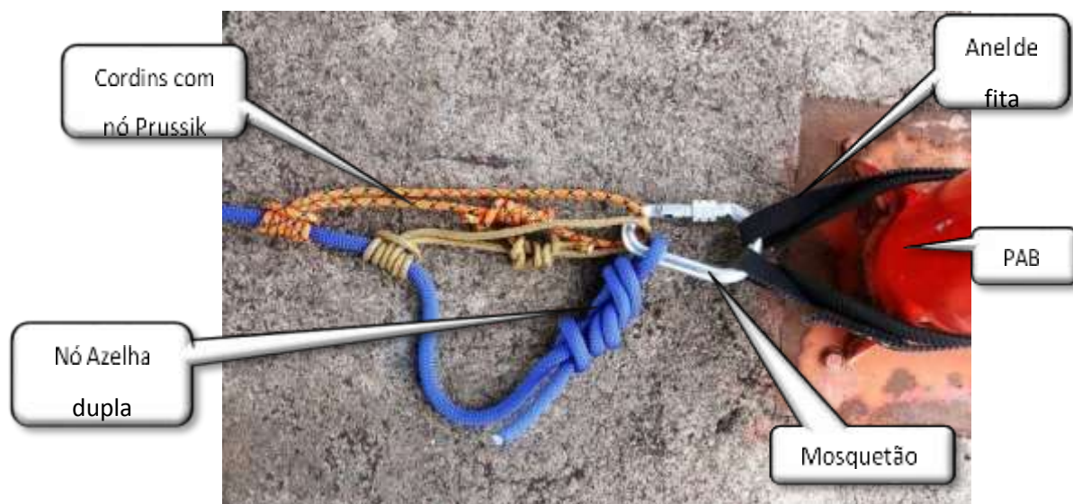
Demonstração de Ancoragem Simples em Ponto-Bomba.
