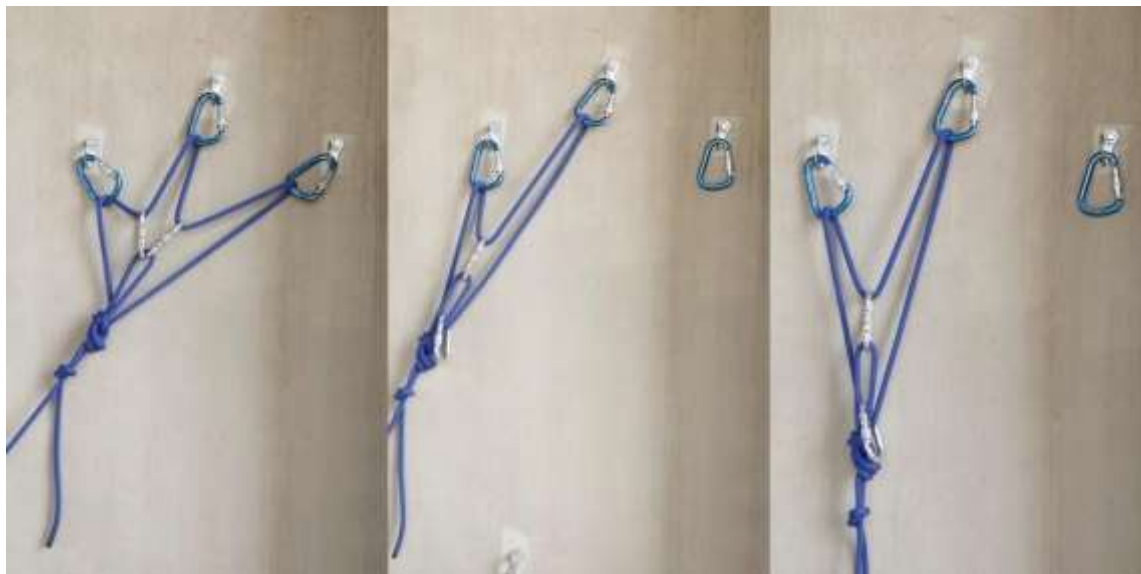
Alteração da direção da via de descida de Ancoragem equalizada em “W” utilizando nó Oito Duplo Alçado e dois mosquetões, mostrando falha ou ruptura de um dos pontos de ancoragem.
