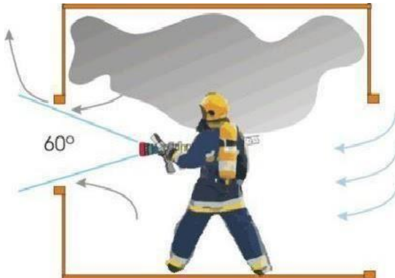
Posicionamento para ventilação por arrastamento hidráulico Fonte: Manual Básico de Combate a Incêndio, Módulo 3, CBMDF, pag. 208
