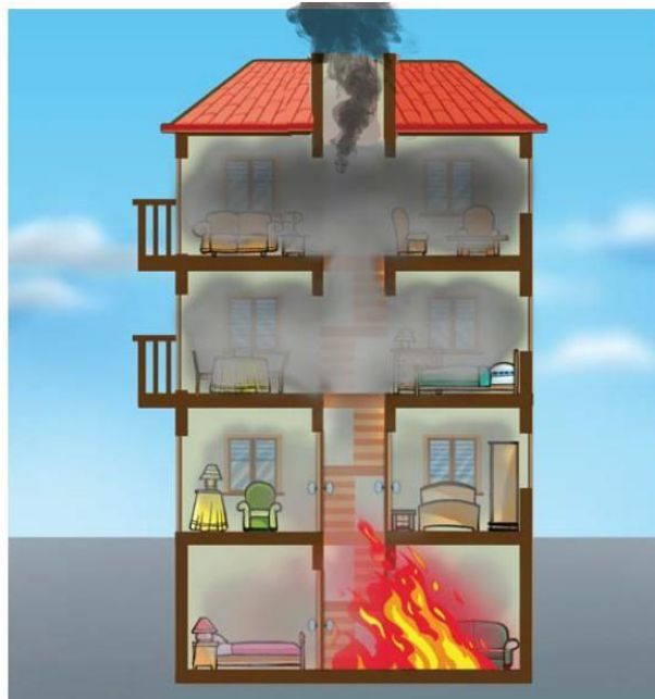
Abertura feita no teto - Ventilação vertical
