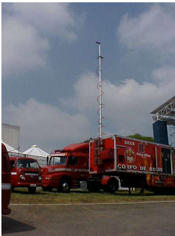
Figura 14. Torre telescópica de uma rádio base móvel
