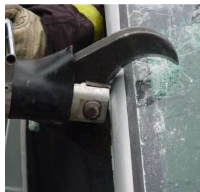
Figura 6.6: Corte da coluna em veículo blindado. Fonte: ESB/CBMSP.
