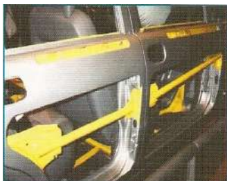
Figura 2.4: Barras de reforço contra impactos lateral. Fonte: Holmatro.
