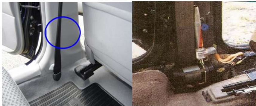
Figura 2.6: Localização do pré-tensionador de cinto. Fonte: Takata Brasil.
