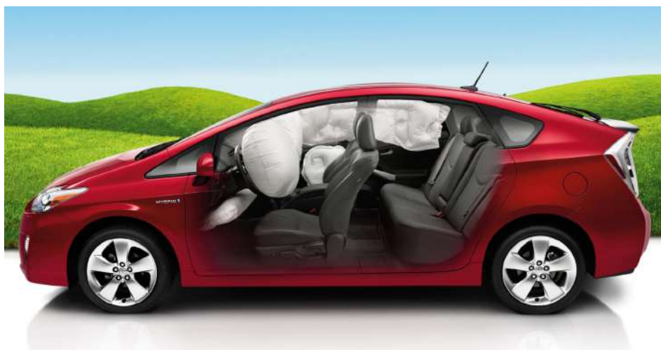
Figura 2.5: Disposição do sistema de Airbags no veículo Prius. Fonte: Toyota.
