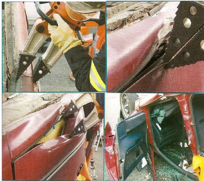
Figura 5.6: Técnica de retirada de porta com veículo capotado. Fonte: Holmatro.
