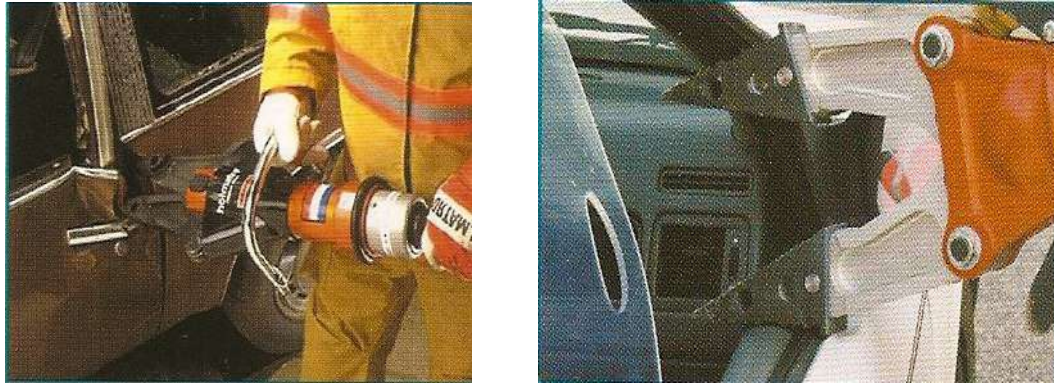
Figura 5.3: Técnicas de obtenção de ponto de apoio para ferramenta. Fonte: Holmatro.
