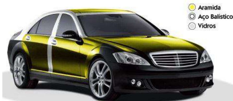
Figura 6.4: Processo de blindagem. Fonte: CRV/CBMSE.
