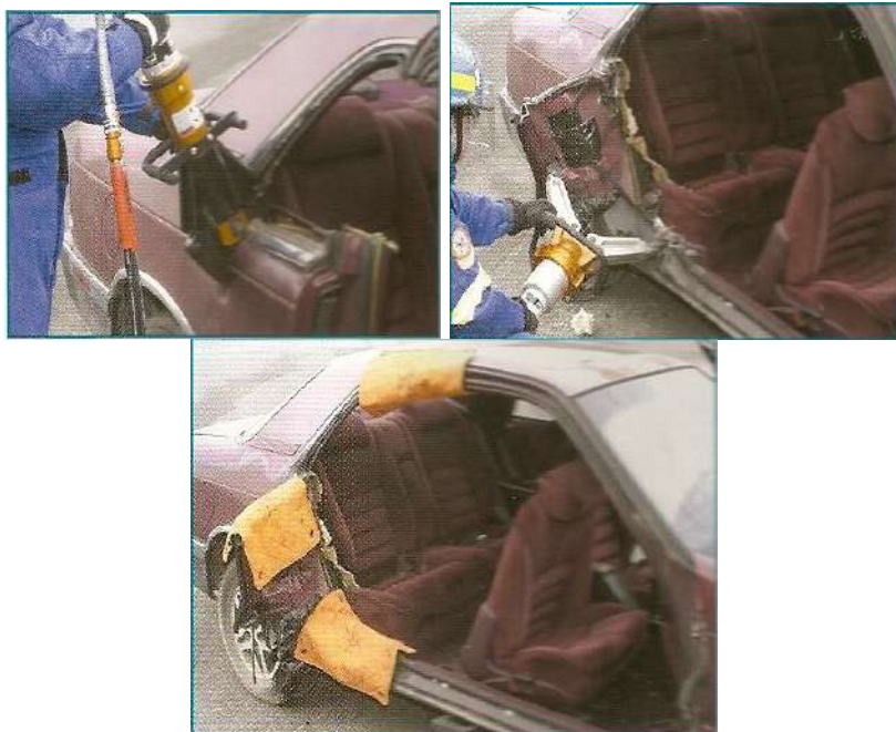
Figura 5.14: Procedimentos para criação de terceira porta. Fonte: Holmatro.
