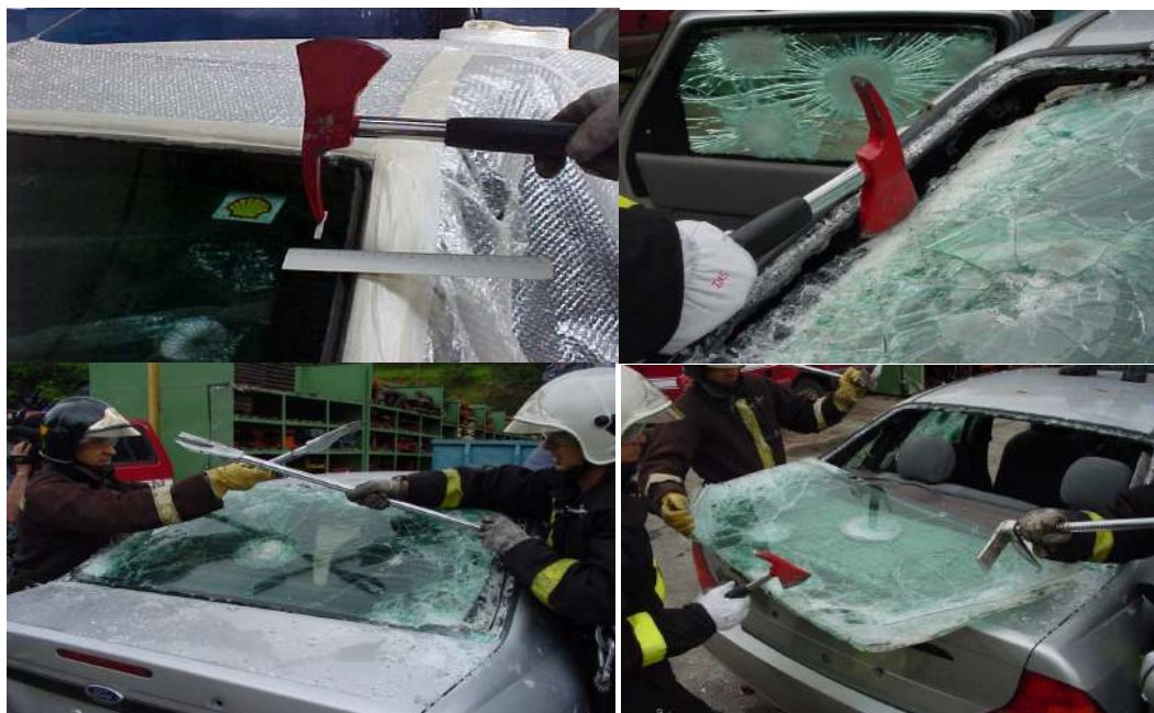
Figura 6.5: Procedimentos de retirada de vidro blindado com machado. Fonte: ESB/CBMSP.
