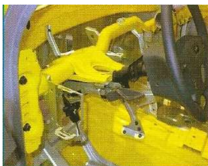
Figura 2.3: Reforço estrutural em painel e assoalho. Fonte: Holmatro.
