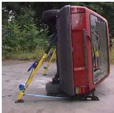
Figura 4.6: Estabilização com Stab – Fast. Fonte: weber-hydraulic.
