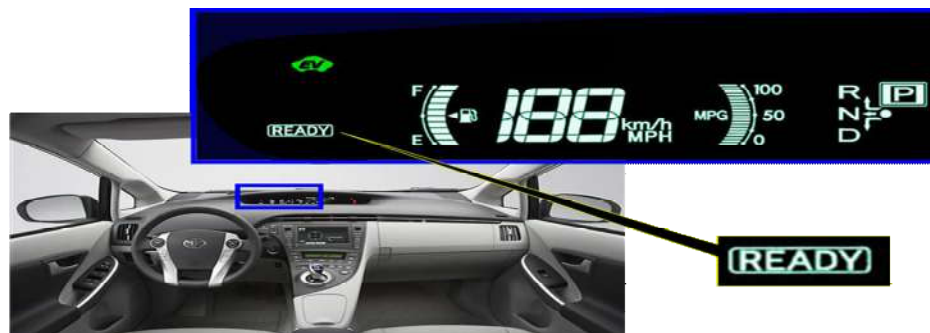
Figura 6.11: Identificação do veículo híbrido em funcionamento. Fonte: Toyota.
