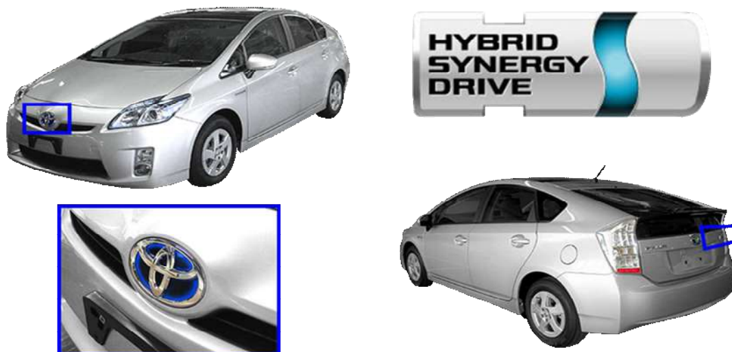
Figura 6.9: Identificação do sistema híbrido na carroceria. Fonte: Toyota.
