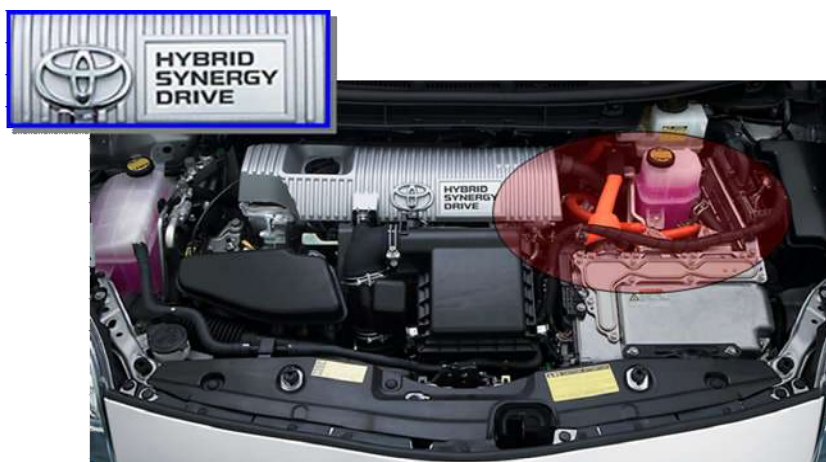
Figura 6.10: Identificação do sistema híbrido no motor. Fonte: Toyota.
